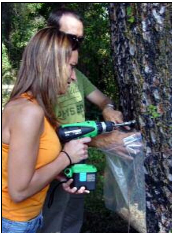
FOTO 1: Proceso de toma de muestra en el que se observa el manejo de la máquina eléctrica y la bolsa de recogida de viruta.
