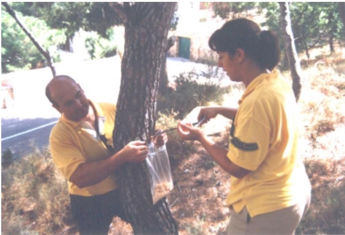
FOTO 1: Proceso de toma de muestras, donde se observa el personal necesario, así como la disposición de los elementos, barrena y bolsa de recogida.
