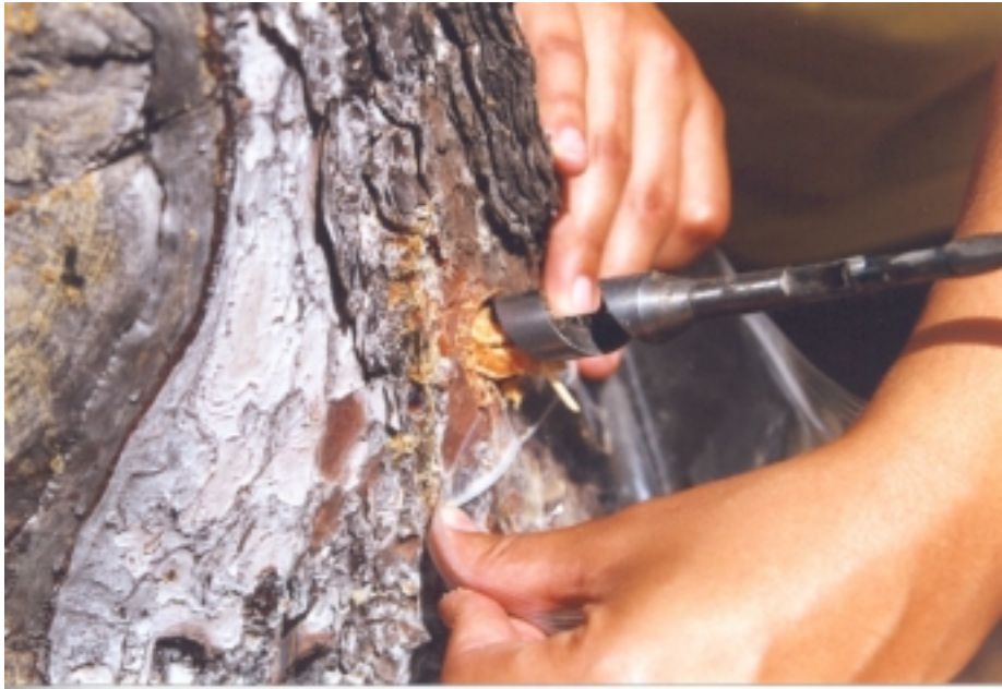
FOTO 2: Detalle de la barrena entrando en el árbol.
