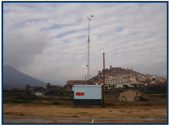
En algunas estaciones se dispone además de sensores para diferentes parámetros meteorológicos, como velocidad y dirección del viento, humedad relativa, radiación solar, presión atmosférica y precipitación. Estos parámetros son útiles para la interpretación de los datos y el conocimiento de la dinámica de los contaminantes en el seno de la atmósfera.
